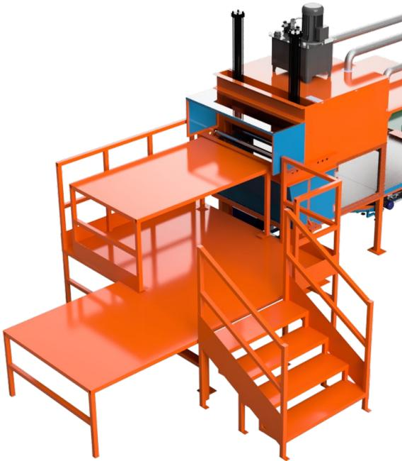
In questa postazione l'operatore toglie la pedana di sostegno dal monitor e lo avvia al ciclo di lavorazione. La postazione è dotata di un ampio banco di lavoro sopraelevato che agevola l'inserimento del materiale nel ciclo produttivo.
