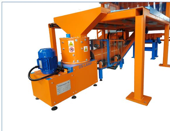
Il trattamento delle lampade di retro illuminazione Neon viene effettuato in tempo reale dalla DS-LAMP posizionata direttamente sotto le postazioni di smistamento.
