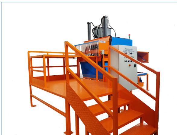
In questa postazione l'operatore toglie la pedana di sostegno dal monitor e lo avvia al ciclo di lavorazione. La postazione è dotata di un ampio banco di lavoro sopraelevato che agevola l'inserimento del materiale nel ciclo produttivo.
